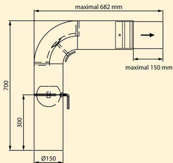
Durch Öffnen der Putztür wird mit dem Griffstück das Schieberohr verstellt. Wenn der Ofen fest montiert ist, kann so nach Bedarf das Rauchrohr abgenommen werden, ohne den Ofen zu bewegen. Bei einem Wandabstand des Ofens von 100 mm kann das Schieberohr vollständig entfernt werden. Die Wandabschlussrosette kann bei diesem System mit dem in der Wand eingemauerten Doppelwandfutter zusammengesteckt werden.
